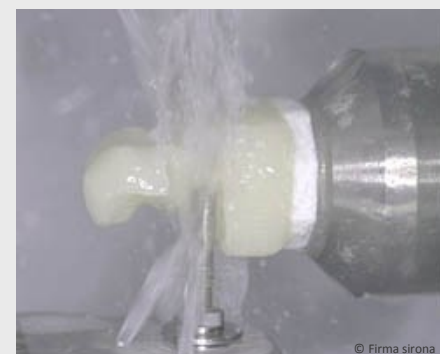
Das Inlay wird innerhalb weniger Minuten aus einem Keramik-Block gefräst.
